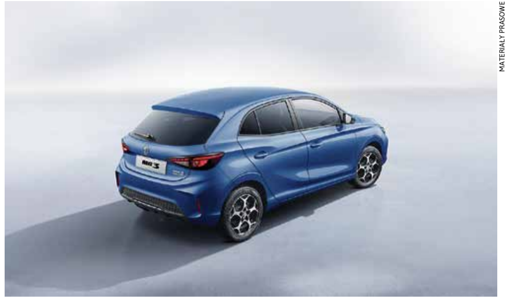
MG3 wyposażono w 1,5-litrowy silnik benzynowy o mocy 75 kW oraz silnik elektryczny o mocy 100 kW
