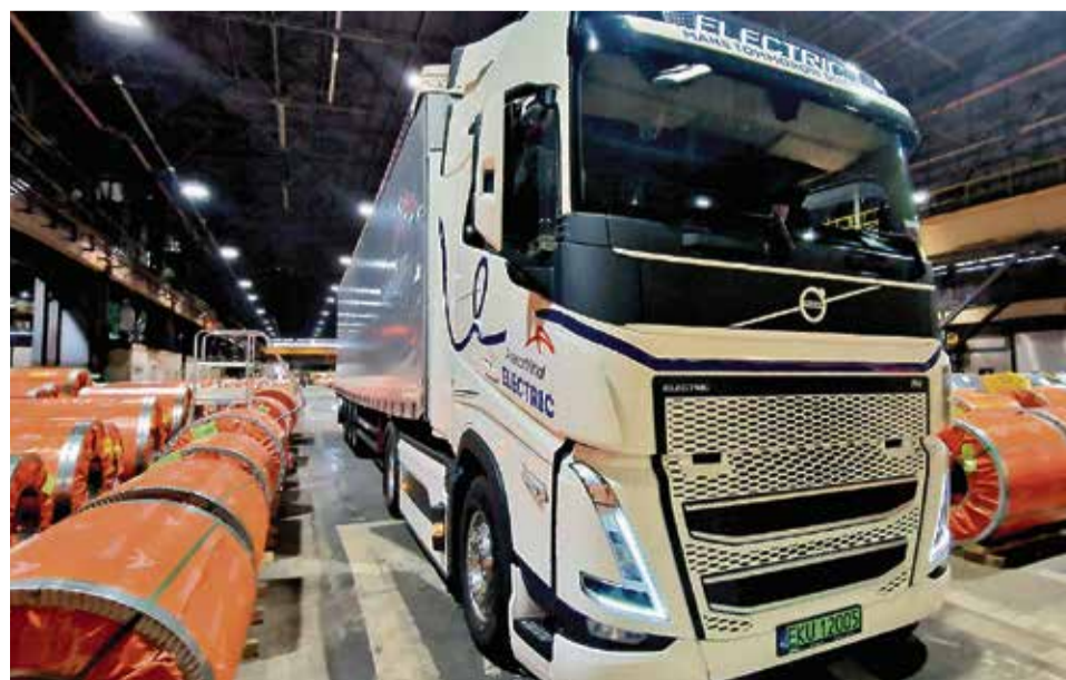
Elektryczna ciężarówka Volvo FH Electric, wyposażona w osiem akumulatorów
