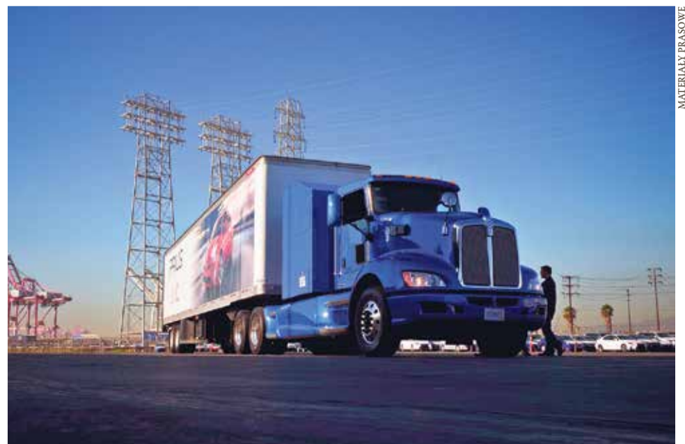
Wodorowa ciężarówka ma napęd elektryczny o mocy ponad 670 KM
