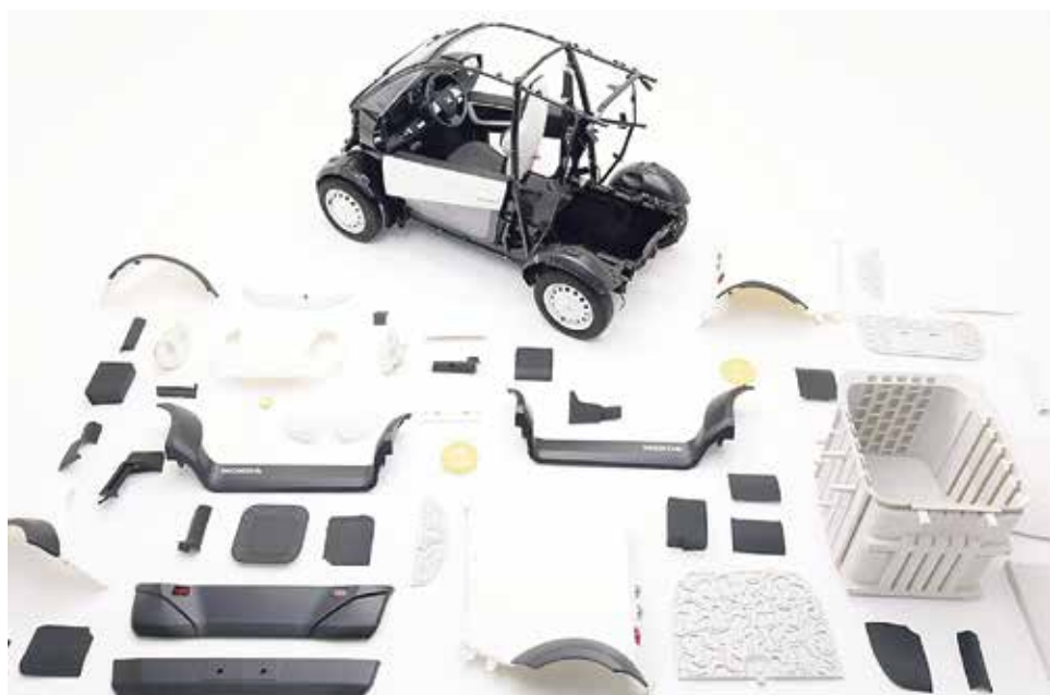
Konstrukcję podwozia Micro Commutera oparto na wytrzymałej i lekkiej ramie o przekroju rurowym
