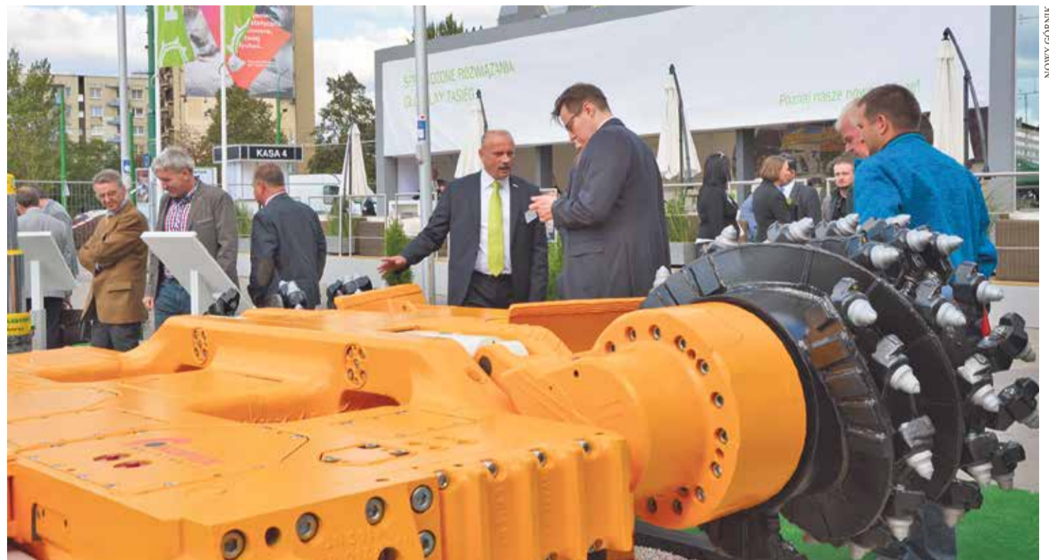
Mikrus II, czyli kompleks ścianowy z głowicą urabiająco-ładującą GUŁ-350, służy do urabiania pokładów cienkich i pofałdowanych. To rozwiązanie innowacyjne na skalę światową
