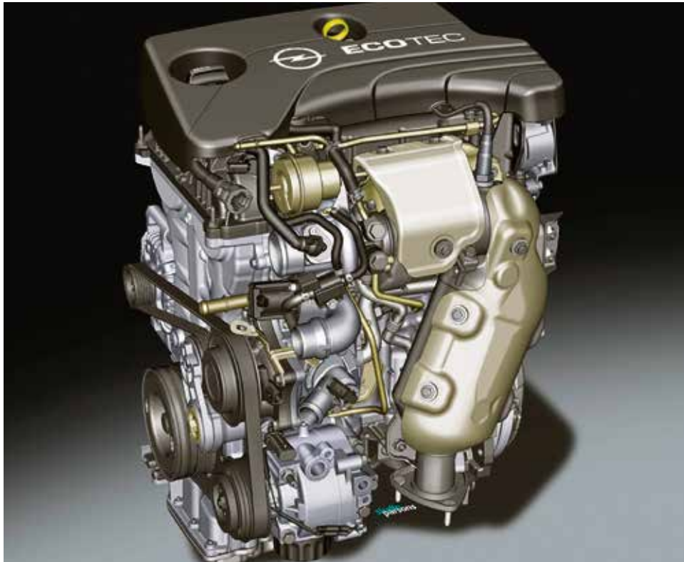
Trzy cylindry i aluminiowy blok lżejszy o 30 proc. od silników obecnie stosowanych
