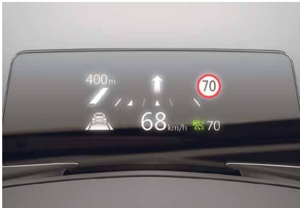
Pełnokolorowy wyświetlacz head-up Active Driving Display
