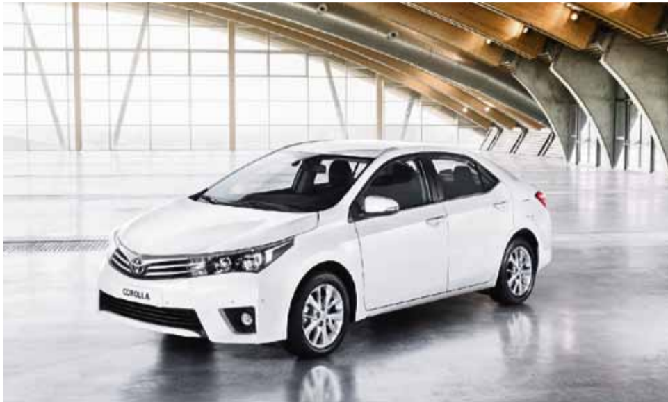
Nowa generacja samochodu ma zwiększony do 270 cm rozstaw osi, a także o 8 cm większą długość
