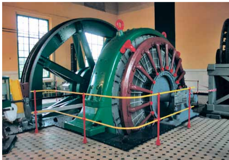
Zabytkowa maszyna wyciągowa z kołem zamachowym o średnicy 6 m i wadze 20 ton
