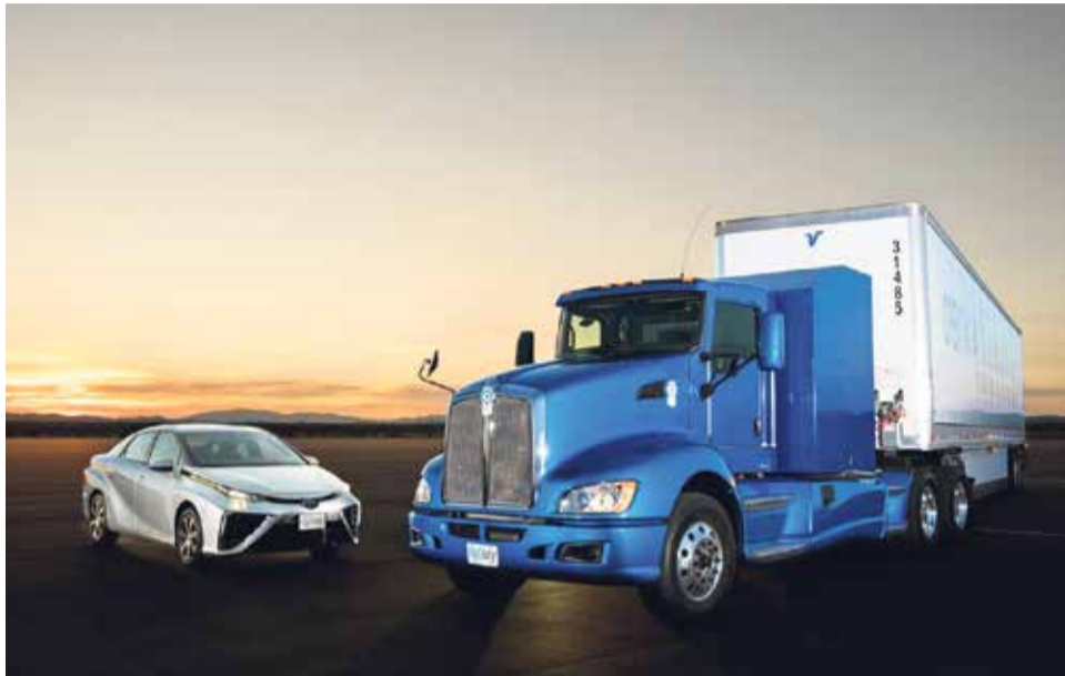
Ciężarówka wykorzystuje dwa zestawy ogniw paliwowych z Toyoty Mirai i baterię o pojemności 12 kWh
