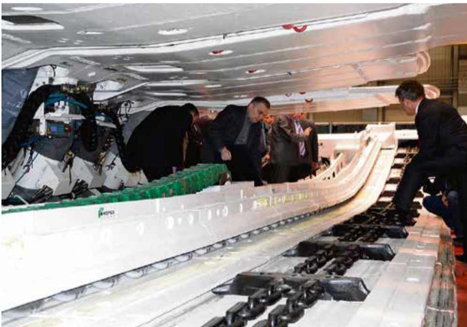
Jednym z flagowych produktów eksportowych będzie kompleks ścianowy Mikrus będący jedynym na świecie rozwiązaniem umożliwiającym skuteczną i opłacalną eksploatację niskich, twardych i pofałdowanych pokładów
