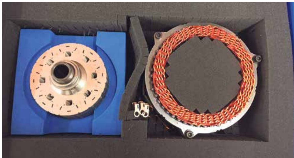
Nowy magnes zawiera mniej neodymu, metalu ziem rzadkich, który zastąpiono lantanem i cerem
