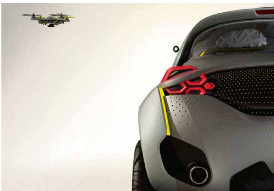
Mały dron – helikopterek startujący z platformy w tylnej części dachu ma wykrywać przeszkody na drodze
